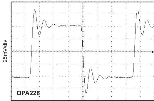
图 55. 小信号阶跃响应, G = 2 , C_{LOAD} = 100\text{pF} , 输入信号 = 50mVp-p。
